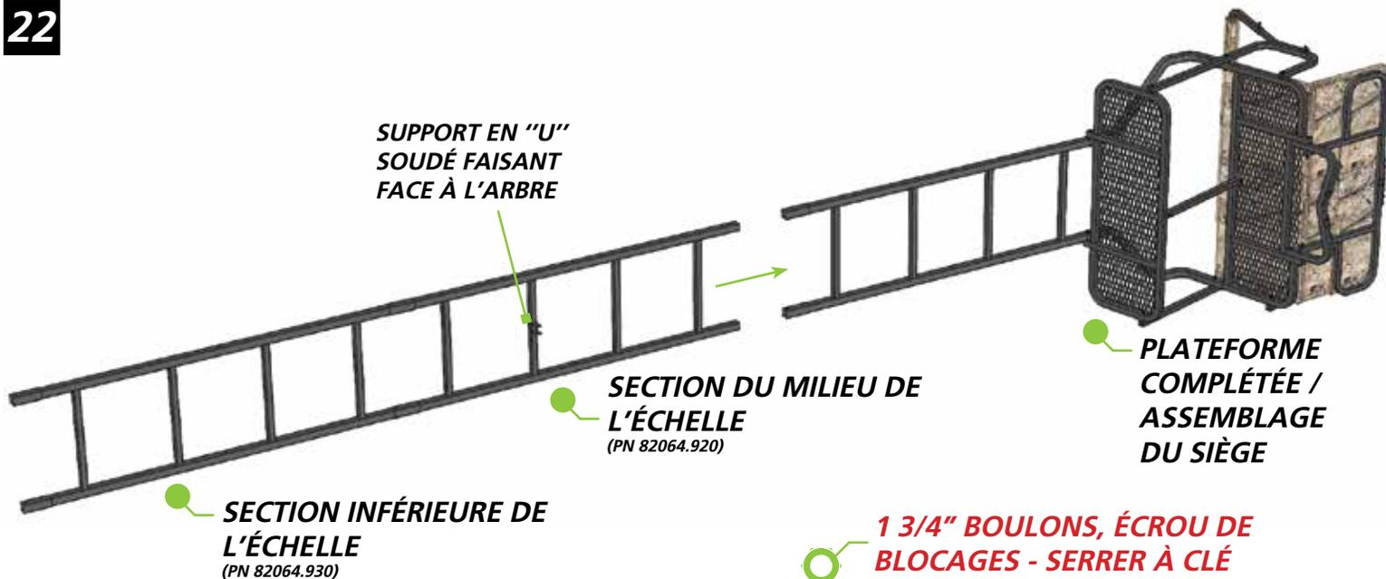
**1 3/4" BOULONS, ÉCROU DE BLOCAGES - SERRER À CLÉ**
