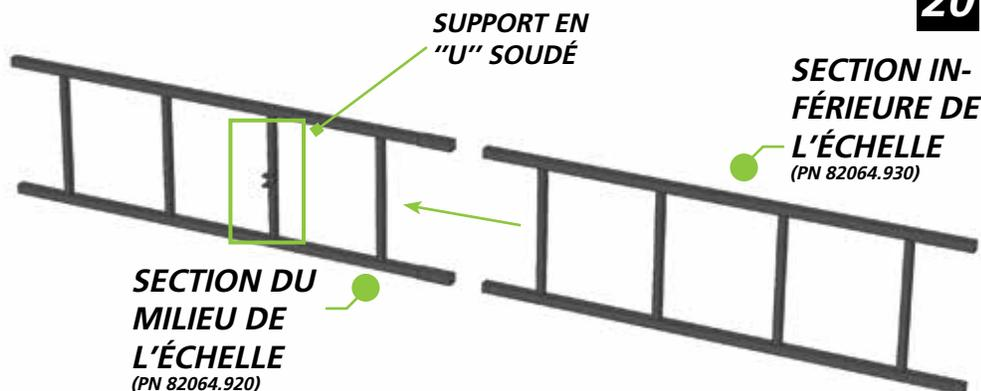
**1 3/4" BOULONS, ÉCROU DE BLOCAGES - SERRER À CLÉ**
