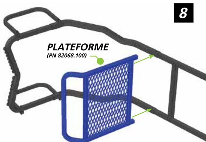
**2 3/4" BOULONS, ÉCROU DE BLOCAGES - SERRER À CLÉ ÉTAPE 9**
