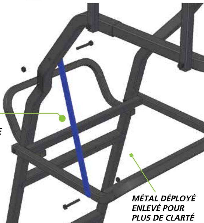
**1 3/4" BOULONS, ÉCROU DE BLOCAGES - SERRER À CLÉ ÉTAPE 9**
