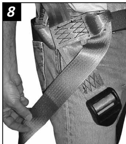
4. Enfilez la courroie pour jambe dans la boucle tel qu'illustré à la **figure 9**. Tirez sur le bout de la courroie pour l'ajuster tel qu'illustré à la **figure 10**. La courroie pour jambe doit être confortablement ajustée (**voir figure 11**). Tirez le bout de la courroie de jambe dans la boucle tel qu'illustré aux **figures 12 et 13**.
