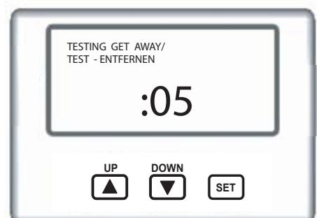
**TIMER TESTEN: DRÜCKEN UND HALTEN** Sie den EINST Knopf, während die LAUFZEIT SEKUNDEN angezeigt werden. Lassen Sie den Knopf los und entfernen Sie sich vom Feeder, wenn die Mitteilung „TEST -ENTFERNEN“ auf dem Display erscheint. Das Display führt einen Countdown von fünf Sekunden durch, bevor der Motor für die eingestellte Anzahl von LAUFZEIT SEKUNDEN aktiviert wird. Diese Testeinrichtung ist nützlich, um die abzugebende Futtermenge zu bewerten.
